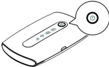
Drücken Sie die Taste
